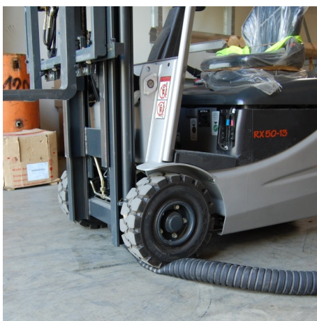
Belastungstest mit dem Abgasschlauch TU
