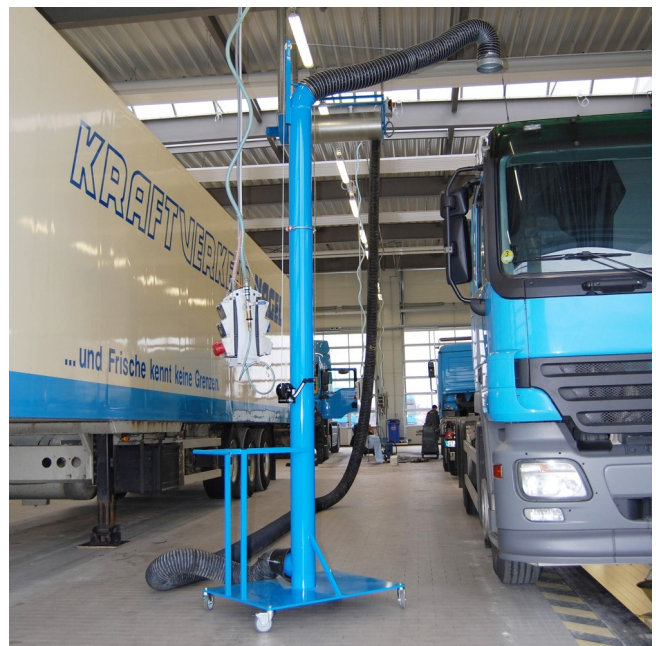
Lkw-Absaugereinheit für obenliegende Auspuffrohre. Die Höhenverstellung erfolgt durch eine stufenlos einrastende, leichtgängige Handkurbel.
