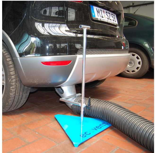
Der AU-Trichter (z.B. Nr. 11712) ermöglicht die Erfassung sehr unterschiedlicher Auspuffformen. Das Halten der eingestellten Neigung erfolgt durch ein Reibgelenk -> eine gute und rationelle Idee! (Bodenplatte ähnl.)
